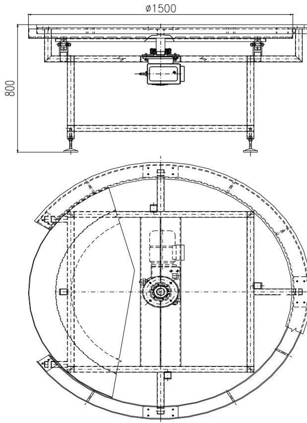
Круговой накопительный стол расположен в конце обвалочного конвейера и предназначен к сортировки мяса после обвалки. Каркас сварен из квадратного тонкостенного профиля, ножки стола сделаны с учетом возможности выравнивания уровня стола. Вращающий диск с диаметром 1500 мм, приводится в движение электрической коробкой передач и по контуру имеет плиту из орбилана.
